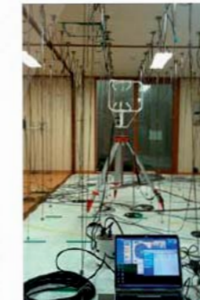
Камера, имитирующая условия окружающей среды
